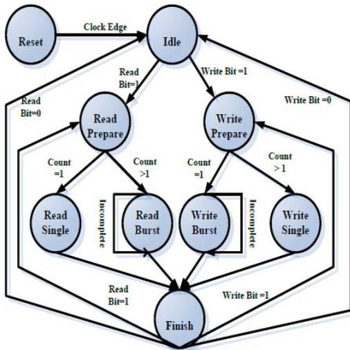
Fig. 2 : DMA Controller Architecture
