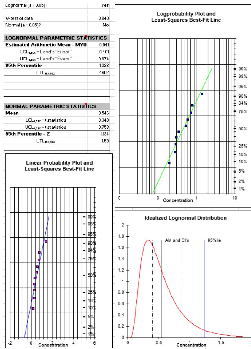
*Figura 2:* Herramienta usada para cálculo de. Límite de confianza superior (UCL).
