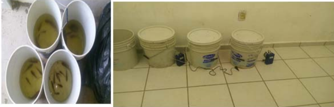
Figura 9: Sistema de oxigenación para traslado de muestras
