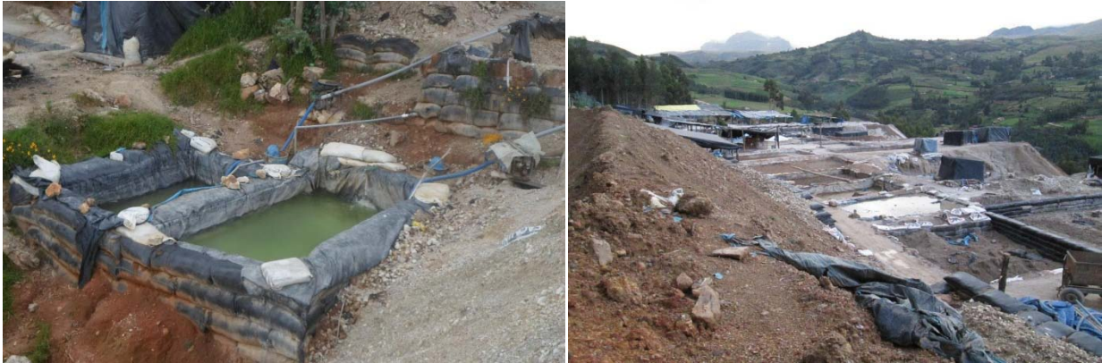
Fig. 16 y 17: Vista Lateral del proceso de beneficio de minerales auríferos oxidados por el método "VAT LEACHING"
