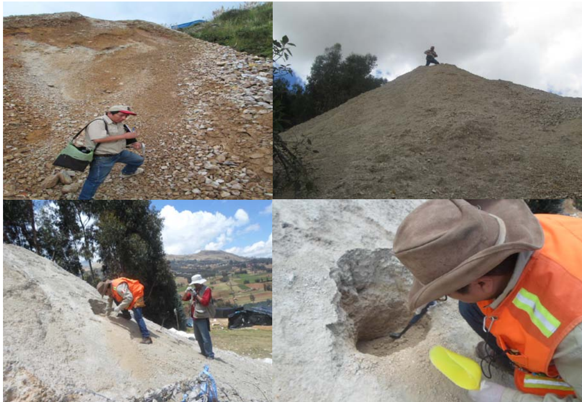
Fig. 10, 11, 12 y 13: Ing. Zegarra realizando la identificación, delimitación y Muestreo sistemático de muestras de relave
