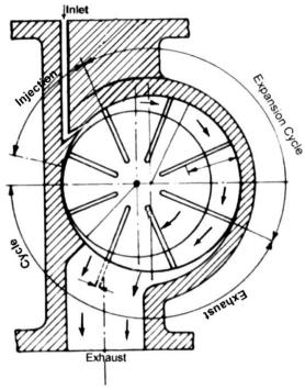
Fig. 1: Air Turbine-Model
