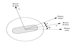
Figure 3 : Motor axes
