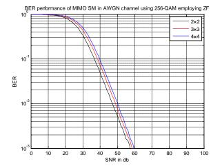
*Figure 6 :* (d) BER performance of MIMO SM using 256-QAM in AWGN channel
