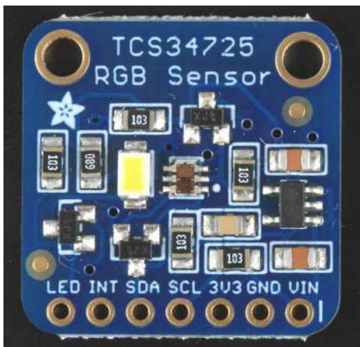
Figure 6 : TCS34725 RGB Color Sensor
