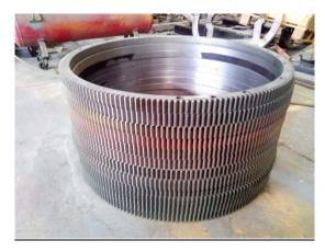
Figure 3 : Spur Gear
