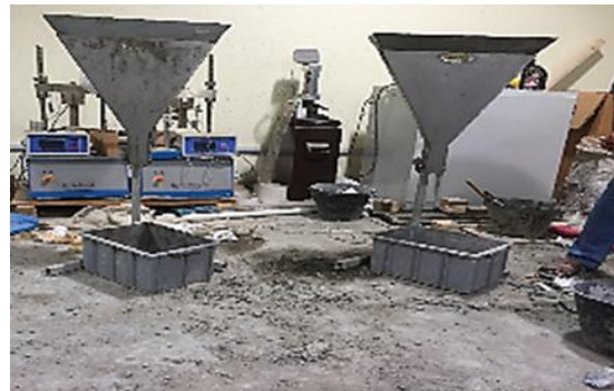
Fig. (1) d: V-Funnel test
