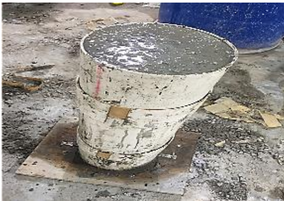
Fig. (1) e: Segregatin test
