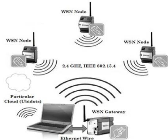
Figure 4: Funcionamiento de un Gateway en una red inalámbrica de sensores (Fuente: NEC)
