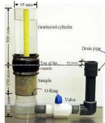
Figura 4: Permeámetro de carga variable
