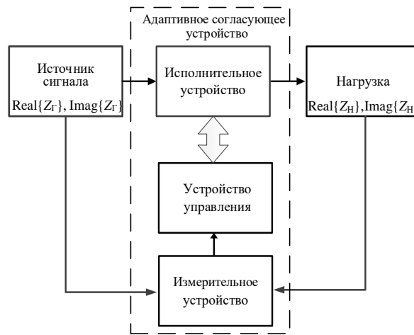
Рисунок 3: Структурная схема адаптивного согласующего устройства
