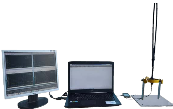
Рисунок 6: Специализированный экспериментальный комплекс расчета и контроля функционирования согласующих устройств в РТС
