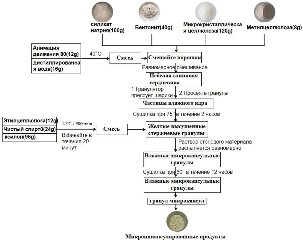
Рис. 2: Схема изготовления микрокапсул
