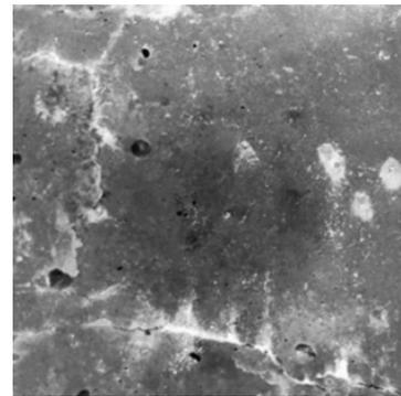
(d) Восстановление трещины после нагружения
