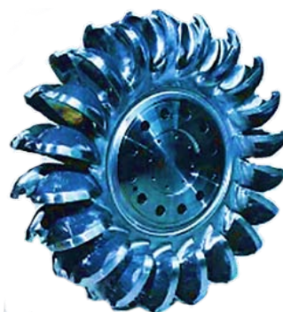
Пел(ь)тона (ковшовая) – от 40 м – 30 кВт-4 МВт;
