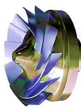
Дериаз(ис)а(диагональная)– от 4 м–до215МВт
