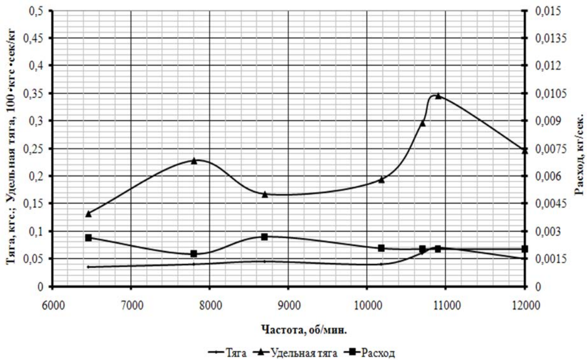
Рис 10 : Зависимость тяги двигателя от частоты вращения золотника; давление в ВК 0,0075 МПа; давление в ресивере 0,015 МПа; 3-х полостной золотник; длина выходного устройства – 400 мм
