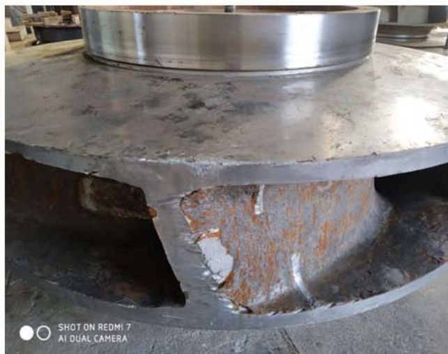
Рис. 4: Износ рабочих колёс НС Амубухара-2
