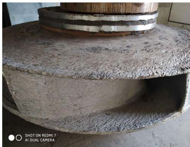
Рис. 4: Износ рабочих колёс НС Амубухара-2
